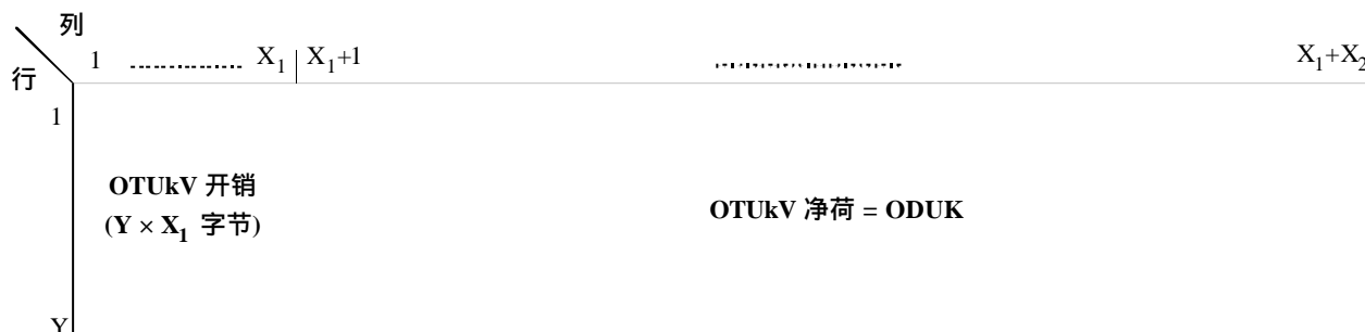
图 C.6 具有不同帧结构的OTUkV
